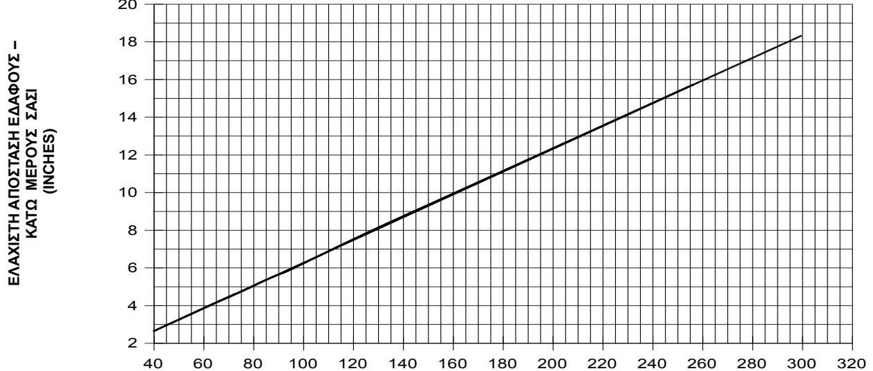
Το ανωτέρω Διάγραμμα καθορίζει εάν το όχημα μπορεί να φορτωθεί με ασφάλεια στο αεροσκάφος, σε σχέση με τις διαστάσεις του μεταξονίου και το ελάχιστο ύψος του κάτω μέρους του σασί, λογιζόμενου στο κέντρο της απόστασης των αξόνων, από το έδαφος, με μικτό φορτίο.
